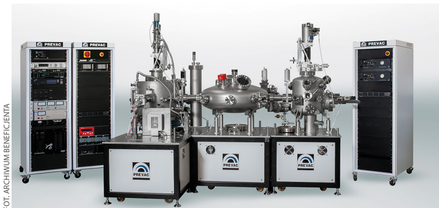
Unikatowa aparatura w postaci modularnej platformy z komputerowym systemem kontroli i sterowania, która daje możliwość wytwarzania cienkowarstwowych struktur
